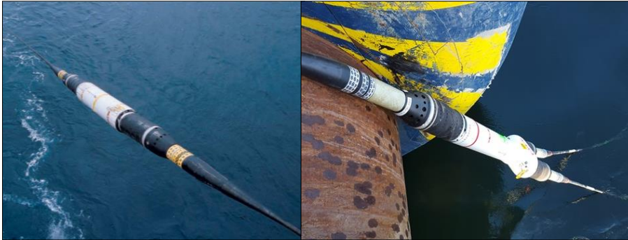
12. ábra. Jelismételő egység (repeater unit) 61 és elágaztató egység (branching unit) 62
