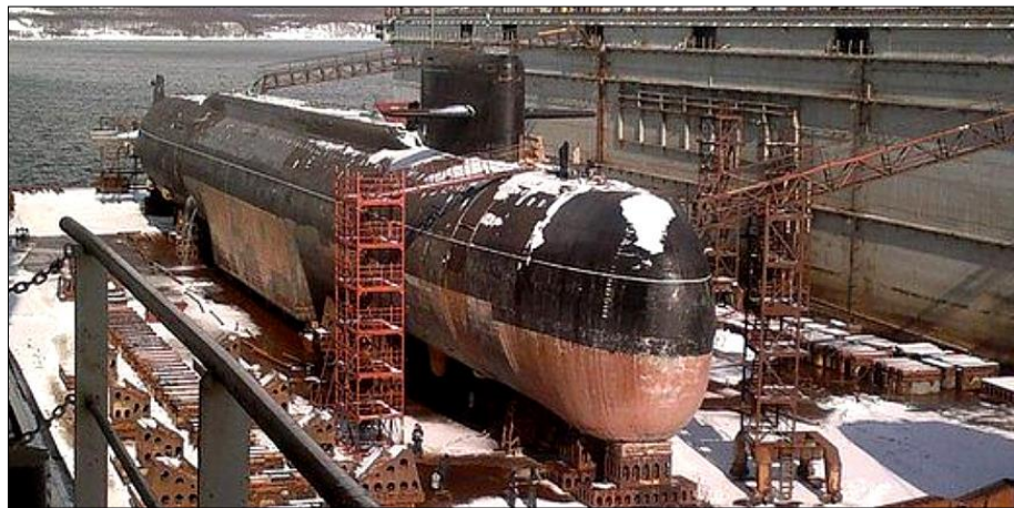
5. ábra. A BSz-136 Orenburg speciális rendeltetésű tengeralattjáró az úszó szárazdokban 24 Jól látható, hogy a ballisztikus rakéták tárolására használt teret a hajótest alsó felének irányába hosszabbították meg, míg a hajótest felső részén megrövidítették.
